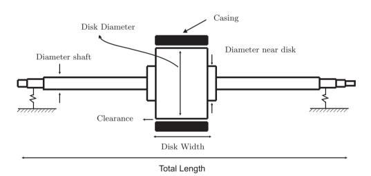
Figure 7.1: Rotor parameters
